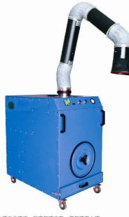
吸气罩吸收的焊接烟尘通过吸气臂进入过滤单元内部,首先撞击分流板,改变气流方向,使气流向上流动,这样可避免直接冲击滤芯,也得到了循环,大颗粒的粉尘被过滤筒收集前先分离出来,细小颗粒经过有 PTFE薄膜的过滤筒过滤分离,过滤后干净的空气通过消声排入外界,完成过滤的全过程。带有PTFE薄膜的过滤筒分离的烟尘颗粒,在脉冲反吹作用下,粉尘落入粉尘容器,进行收集。
